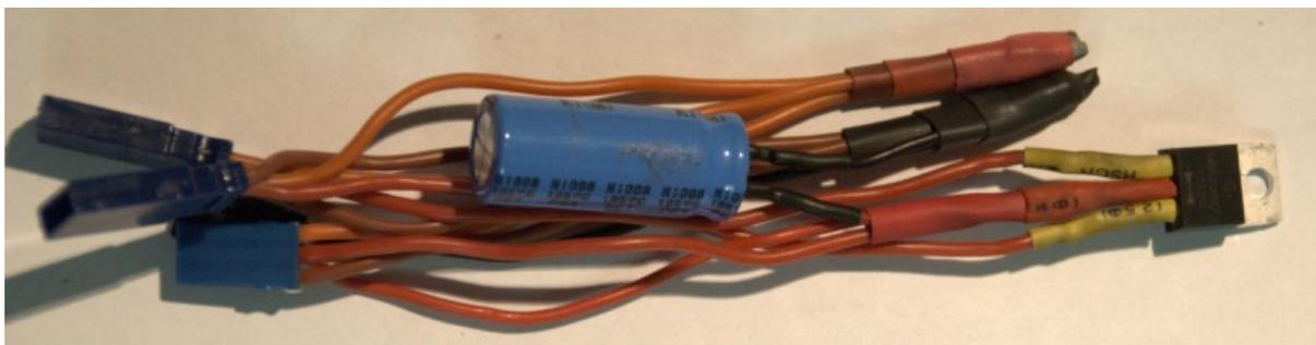
Der mittlere Anschluss der Schottky-Diode liefert jetzt den Strom/Spannung für die Empfangsanlage und Servos im Modell. Der Spannungsabfall beträgt ca. 0.3V. Bei den T-Reglern von Graupner kann man die Spannung dementsprechend einstellen.
